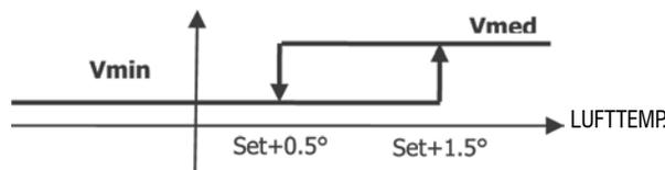
For å føre fuktighet til settverdien vil viften (og ventilen, hvis montert) bli aktivert selv om romtemperaturen allerede har nådd det programmerte settpunktet (angitt på displayet). Hvis romtemperaturen skulle falle for langt under denne terskelen vil styring bli midlertidig deaktivert.
